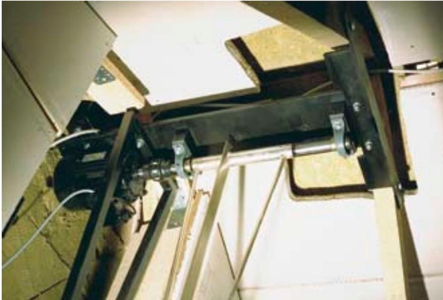
**Maschinengetriebenes Pendel, verschleißfreier magnetischer Antrieb**
