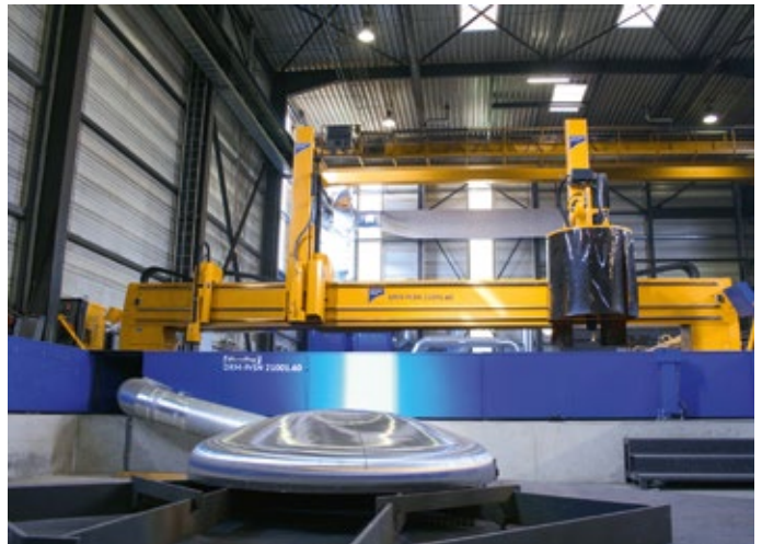
Für den Zuschnitt des Kunstwerks nutzte Slawinski die DRM Baureihe von MicroStep, die seit 2016 beim Klöpperbodenspezialisten im Einsatz ist. Sie ermöglicht mittels Plasmarotator, Scantechnologie und Nadelmarkierer die 3D-Bearbeitung von Behälterböden und auch Blechen. (Foto: © MicroStep Europa GmbH)
